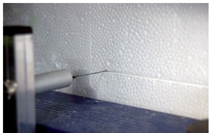
Abb. 5: Hauptversuch, Arbeiten mit Styropor-Schneider
