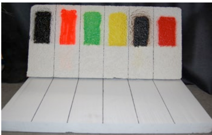
Abb.22: Keine Schäden an Polystyrol-Dämmung
