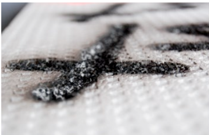
Abb. 3: Vorversuch, Farbspray auf Polystyrol
