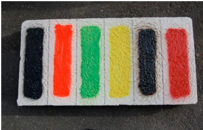
Abb.20: Sprühlackfarbe auf Anti-Graffiti-Schutzsystem
