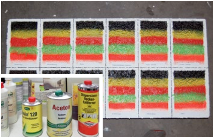
Abb. 9: Testfläche und verwendete Graffiti- und Farb-Entferner
