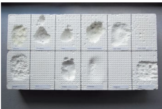
Abb. 4: Vorversuch, Graffiti-Entferner auf Polystyrol
